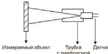
Необходимо убедиться, что измеряемый объект полностью располагается в пятне измерения пирометра, т.е. прибор видит только измеряемый объект. Чем больше измеряемый объект, тем больше может быть расстояние измерения. Чем меньше измеряемый объект, тем меньше должно быть расстояние измерения.
