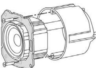
Опорное кольцо вставки динамиков покрыто пленкой, обеспечивающей акустическое разделение вставки и переднего звукового отверстия.
