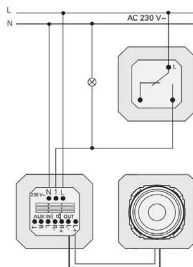
Если в помещении нет постоянной фазы, то в качестве альтернативы можно подключить радиоприемник скрытого монтажа через питающую фазу. Но в этом случае радиоприемник скрытого монтажа будет работать только при включенном освещении.
