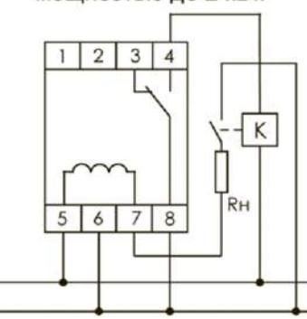
Рис. 2. При нагрузке с потребляемой мощностью выше 2 к Вт.
