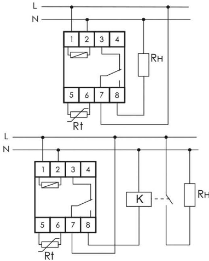
Схема подключения с применением контактора
