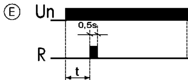
E- замыкание контактов исполнительного реле на время 0,5 секунды. По истечении заданного времени  $t$ .
