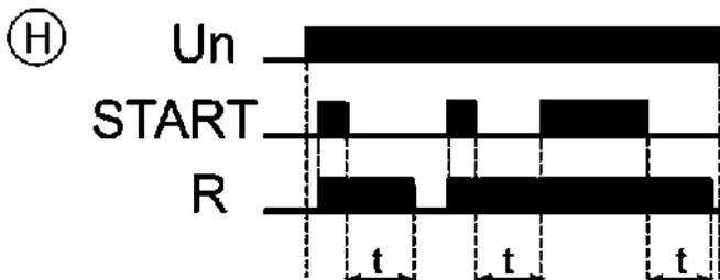
Ⓗ - подача напряжения на вход START вызывает включение исполнительного реле, а сброс его начало отсчета времени  $t$ . Подача последующих импульсов START и сброс его вызывает продолжение цикла работы на время  $t$ .
