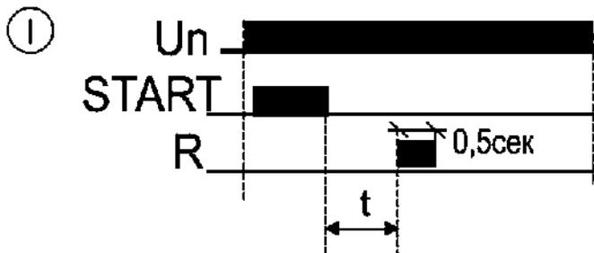
Ⓘ - По окончании подачи напряжения на вход START начинается отсчет заданного времени  $t$  по истечении, которого, контакты исполнительного реле замыкаются на время - 0,5 сек.
