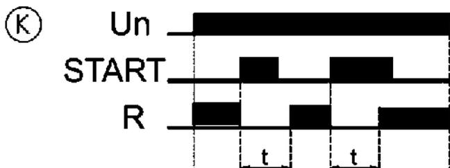
Ⓚ - Выключение реле на определенное время  $t$ . При подаче напряжения на вход START начинается отсчет времени. В ходе отсчета устройство не реагирует на сигнал START.
