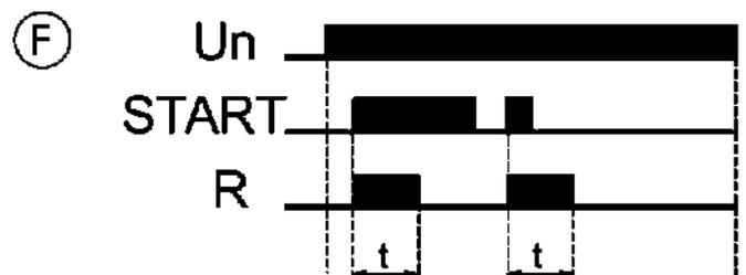
F- контакты исполнительного реле замыкаются на установленное время  $t$  при подаче напряжения на вход START. В этот период времени устройство не реагирует на импульсы START.
