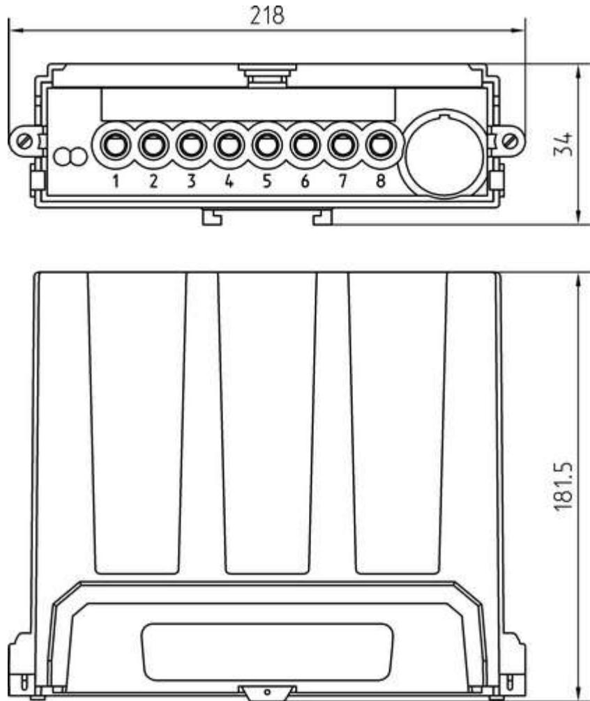
Рисунок А.5 – Габаритный чертеж счетчика «Меркурий 238»
