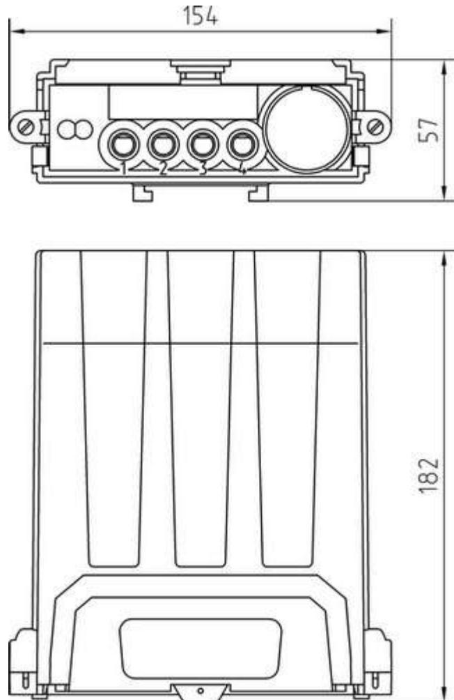
Рисунок А.2 – Габаритный чертеж счетчика «Меркурий 208»
