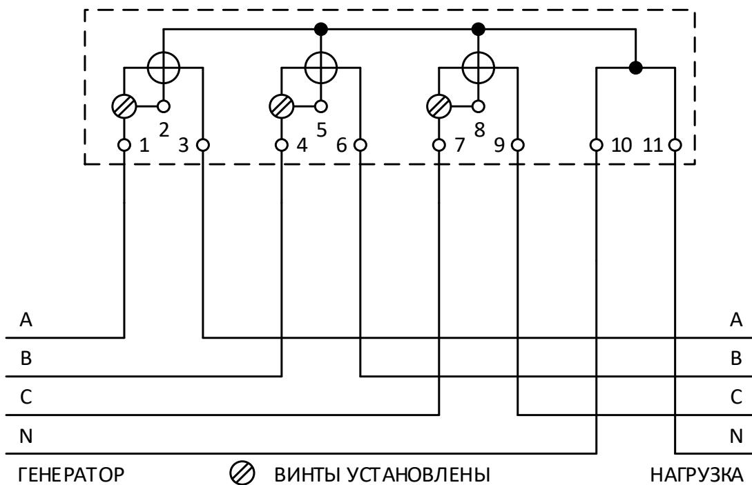
Рисунок Б.3 – Схема подключения счетчиков «Меркурий 234»,
