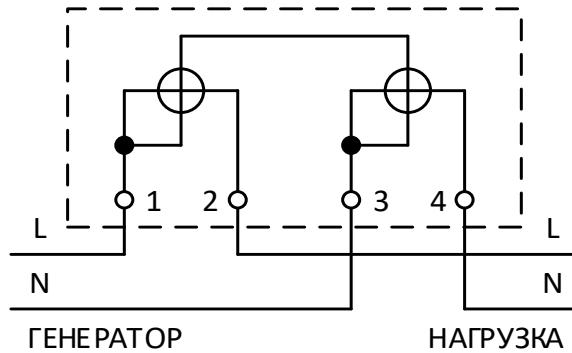
Рисунок Б.1 – Схема подключения счетчиков «Меркурий 204», «Меркурий 208»,
