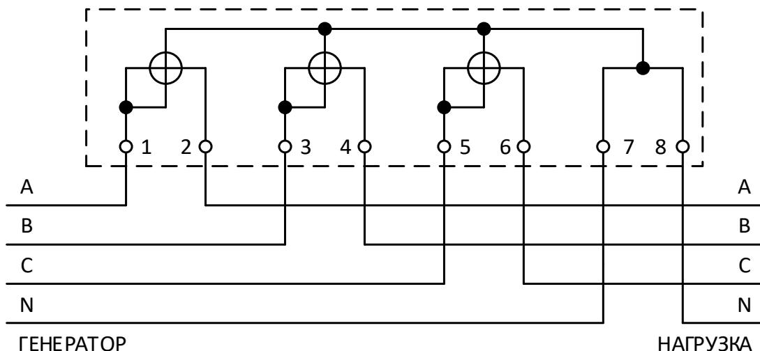
Рисунок Б.2 – Схема подключения счетчиков «Меркурий 238»,
