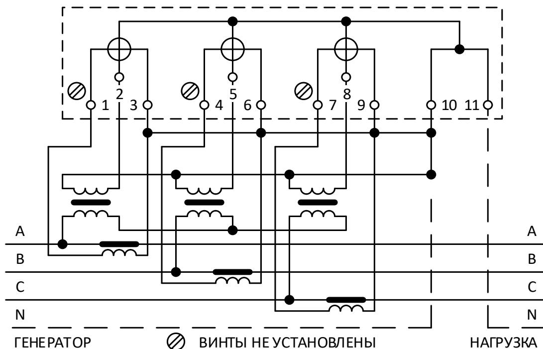
Рисунок Б.6 – Схема подключения счетчиков «Меркурий 234»,
