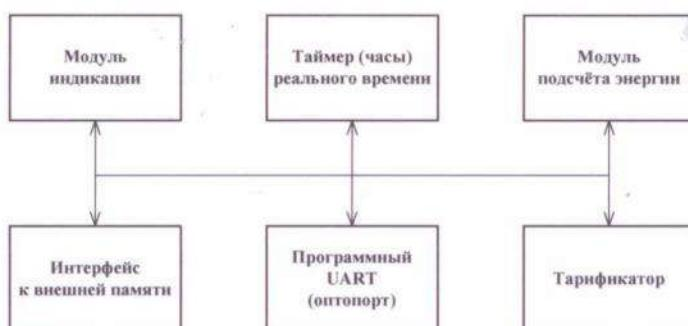
Рисунок 3 - Структура программного обеспечения «Меркурий 230»
