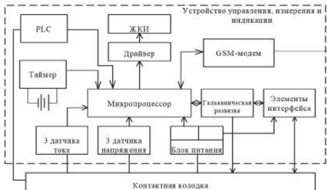
Рисунок 1 - Структурная схема счётчика.
