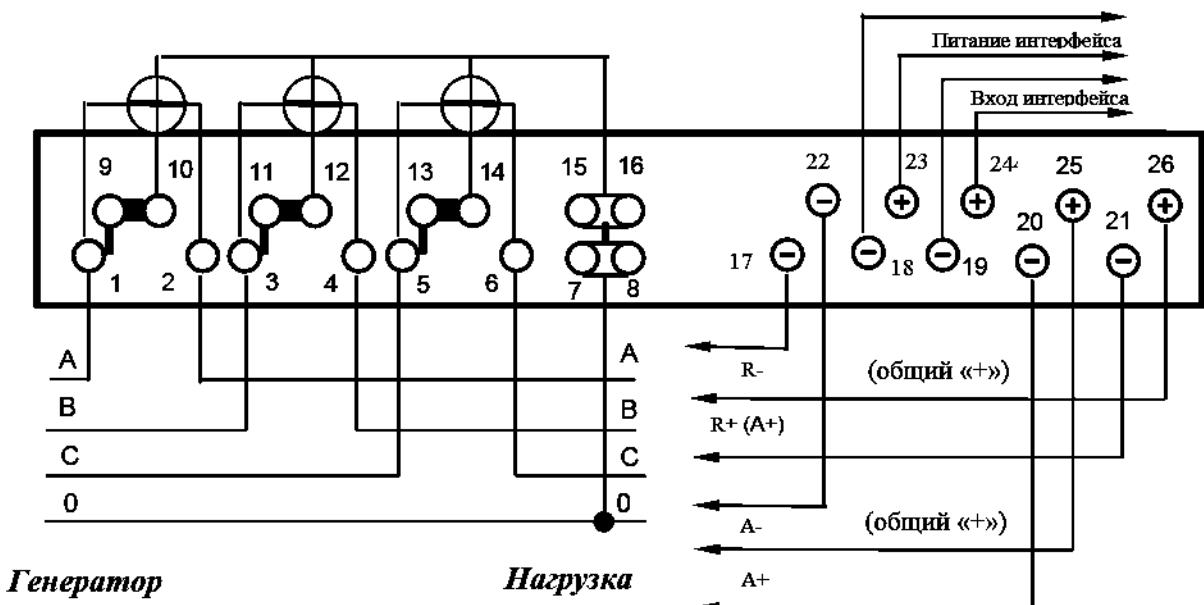
Рисунок Б.1 - Схема неносредственного подключения счётчика
