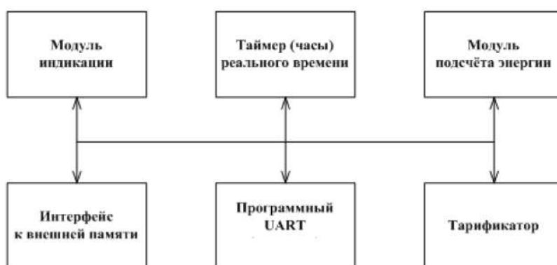
Рисунок 7 - Структура программного обеспечения «Меркурий 231»
