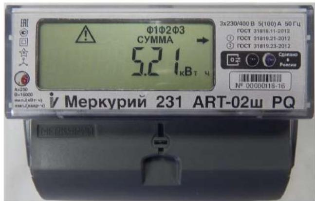
Рисунок 5 - Общий вид счетчика электрической энергии статического трехфазного «Меркурий 231A(R)Т-0Хш»
