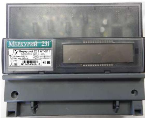
Рисунок 4 - Общий вида счетчика электрической энергии трехфазного статического «Меркурий 231A(R)(T)-0X»
