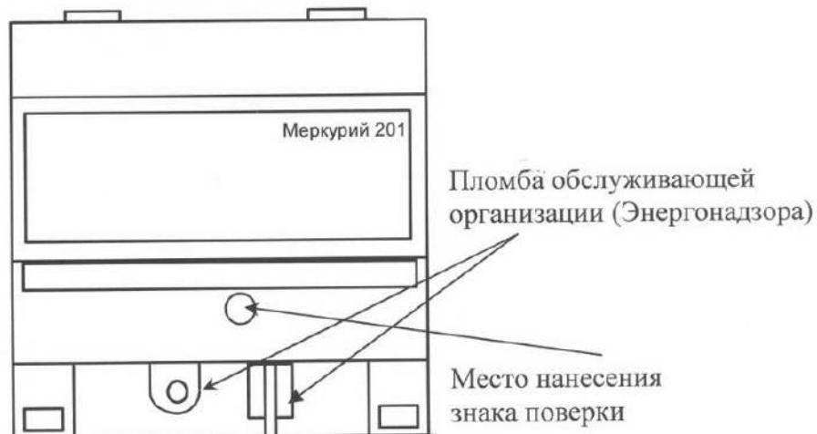
Рисунок 6 - Схема пломбировки от несанкционированного доступа, обозначение места нанесения знака поверки счётчиков «Меркурий 201.1», «Меркурий 201.2», «Меркурий 201.22», «Меркурий 201.3», «Меркурий 201.4», «Меркурий 201.42», «Меркурий 201.5», «Меркурий 201.6»
