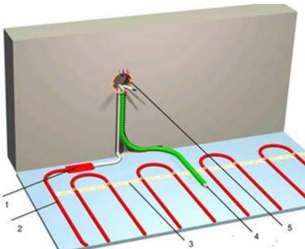
Рис. 4. Монтаж датчика температуры в системе “Теплый пол”.
