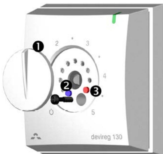
Рис. 6. Установка ограничителей температурного диапазона.
