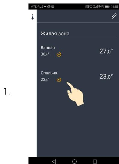
Список комнат, измеренные и заданные температуры находится в правом меню программы. На этом экране отображается состояние регулятора для каждой комнаты (вкл. или выкл. нагрев, работает ли регулятор по временной программе и пр.) Если в этом меню нет искомой комнаты, проверьте, какой дом вы выбрали (список домов находится в левом меню, вверху списка команд)
