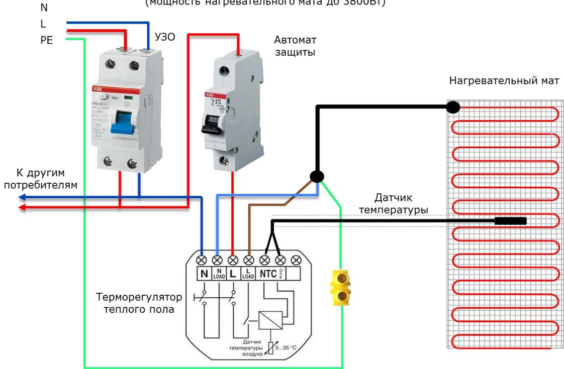
Электрическая схема подключения теплого пола в квартире
