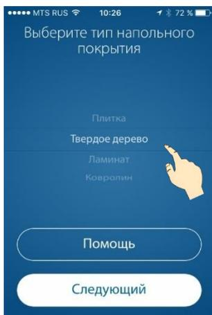
Выберите тип покрытия пола, установленного над нагревательной системой. Это позволит автоматически установить рекомендованные ограничения и температуры пола:
