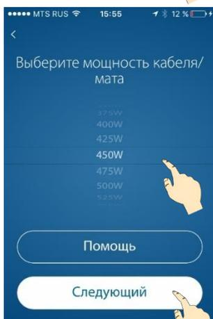
Выберите мощность нагревательной системы. Это позволит терморегулятору правильно рассчитывать потребление энергии нагревательной системой.
