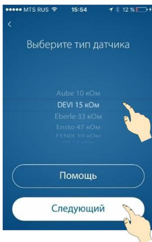
Выберите тип датчика пола, который подключен к терморегулятору.
