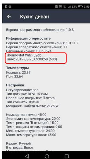
В открывшемся экране содержится полная информация о терморегуляторе, измеряемые температуры и настройки. **Установленная в терморегуляторе дата и время, синхронизированы с вашим роутером.**
