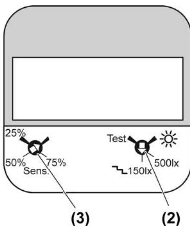
рисунок 13: Регулятор настройки накладки сигнализатора движения 1,10 м
