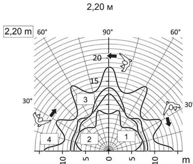
рисунок 5: Дальность действия при тангенциальном направлении движения для накладки сигнализатора движения 2,20 м, монтажная высота 2,20 м
