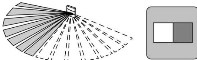
рисунок 9: Ограничение зоны обнаружения накладкой сигнализатора движения 1,10 м
