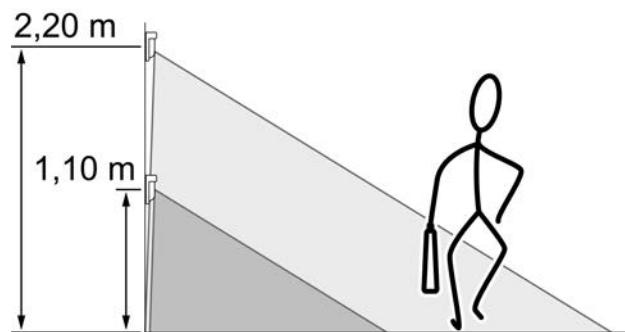
рисунок 4: Поле обнаружения и монтажная высота накладки сигнализатора движения
