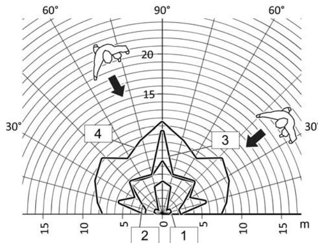
рисунок 3: Дальность действия при радиальном направлении движения для накладки сигнализатора движения 1,10 м
