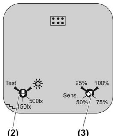
рисунок 14: Регулятор настройки накладки сигнализатора движения 2,20 м
