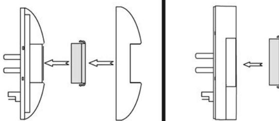
рисунок 14: Монтаж заслонки серии CD/LS и А
