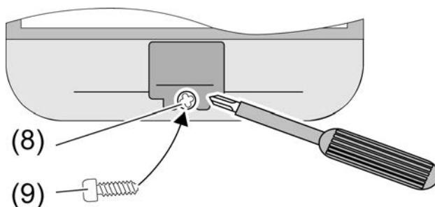
рисунок 15: Фиксация выключателя
