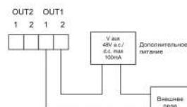
Использование цифровых выходов в качестве импульсных
