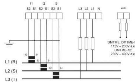
Подключение через трансформаторы напряжения не необходимо при высоковольтной сети
