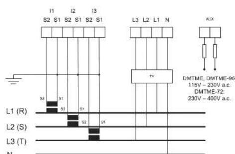
Трехфазное подключение с использованием схемы Арон (два трансформатора тока, два трансформатора напряжения)
