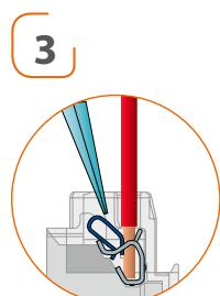
Для извлечения кабеля использовать отвертку
