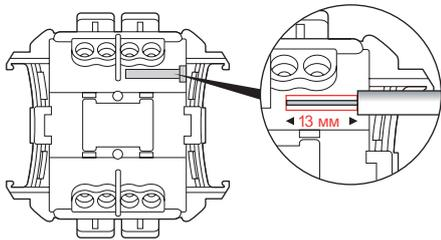
Требуемая длина зачищенного кабеля - 13 мм. Используйте шаблон, расположенный на задней панели механизма, для определения точной длины. Емкость клемм : от 1,5 мм<sup>2</sup> до 2,5 мм<sup>2</sup> (1 или 2 проводника).
