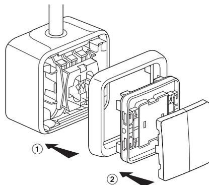
Крепление верхней части к монтажной коробке, обеспечивающее степень защиты выключателя IP55, выполняется поворотом отвертки на 1/4 оборота.
