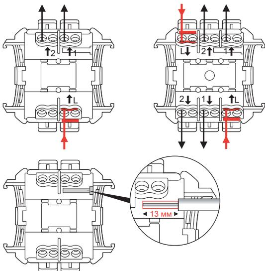
Требуемая длина зачищенного кабеля - 13 мм. Используйте шаблон, расположенный на задней панели механизма, для определения точной длины. Емкость клемм : от 1,5 мм<sup>2</sup> до 2,5 мм<sup>2</sup> (1 или 2 проводника).
