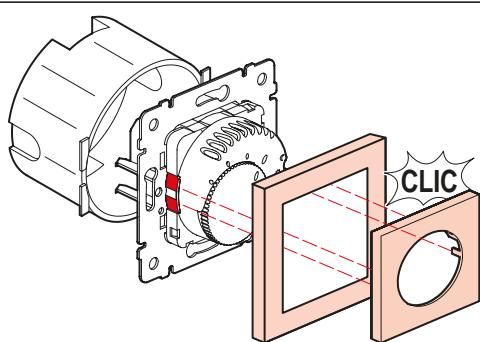
• Después de un montaje adecuado, la protección contra descargas eléctricas a partes activas satisface los requerimientos de la clase de protección II (aislamiento reforzado).
