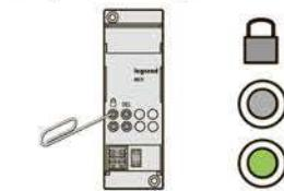
Нажать на кнопку подключения программирования модуля сценариев
