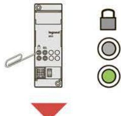
Нажать на кнопку подключения программирования модуля сценариев.
