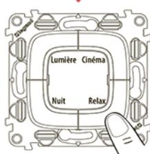
Для программирования нажимать на клавишу в течение более четырех секунд.
