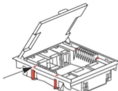
При установке не использовать захваты, поставляемые с напольной коробкой (1). Разрешается использовать только захваты, поставляемые с пластиковой монтажной коробкой (2).
