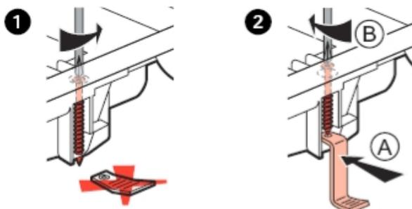
После застывания бетона необходимо при помощи инструмента разрушить пластмассовый шаблон для последующей установки напольной коробки.
