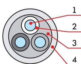
1. Однопроволочная (сечение 1,5–10 мм<sup>2</sup>) или многопроволочная (сечение 16–35 мм<sup>2</sup>) медная жила.
