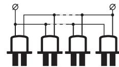
Реле сработает в случае затопления какого либо из зондов.
