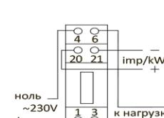
Схема включения счетчика НЕВА 102, НЕВА 105
