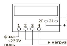
Схема включения счетчика НЕВА 101, НЕВА 104
