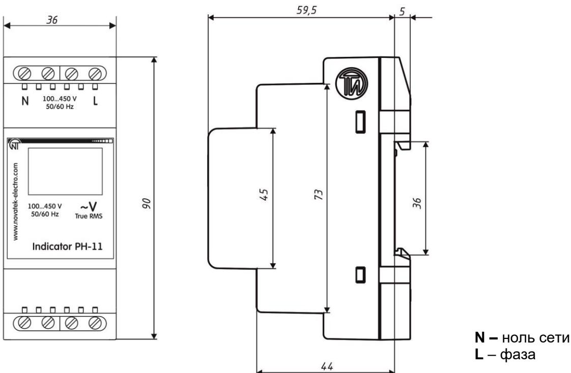
Рисунок 1 – Габаритные и установочные размеры РН-11
