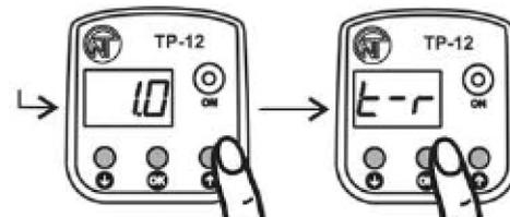
Кнопками **↓** или **↑** измените значение параметра в пределах от 0 до 10 минут с шагом 1 мин. При установке 1 мин., изделие включит / отключит нагрузку через 1 минуту
