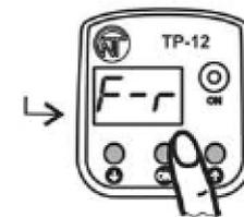
Кратковременно нажмите кнопку **OK** для сброса всех настраиваемых параметров к заводским установкам, при этом на дисплее отобразится параметр меню «F-r» (если удерживать нажатой кнопку **OK** в течение 3 секунд, Вы выйдете из меню настроек сброса к заводским установкам и изделие перейдет к нормальному режиму работы)
