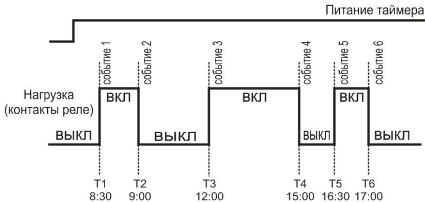
Рисунок 3.5 – Включение нагрузки на примере суточного режима работы
