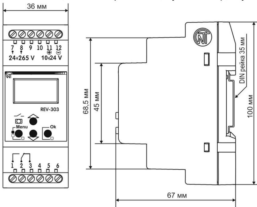
Рисунок 3.1 – Внешний вид и габаритные размеры таймера
