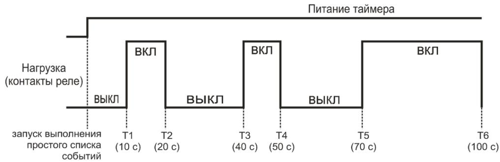
**Рисунок 3.6** – Включение нагрузки на примере простого режима работы
