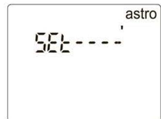
7. Активизируйте режим **On** ☆ с помощью клавиш + и -, нажмите **enter**. С этого момента таймер будет автоматически рассчитывать и изменять астрономические параметры, работая по годовому циклу.
