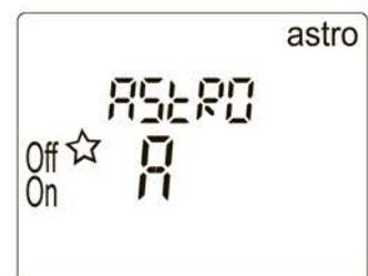
8. Для двухканального таймера: выберите канал **C1** или **C2** помощью клавиш + или -, далее нажмите **enter**. Символ ☆ на основном меню указывает, какой канал работает в астрономическом режиме.
