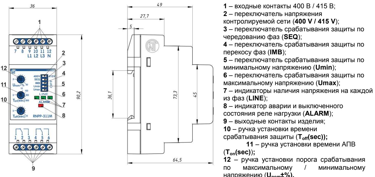
Рисунок 1 – Органы управления, габаритные и установочные размеры RNPP-311M
