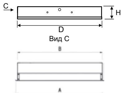
Применение в светильниках отраженного света серии TLC RF рассеивателя из перфорированного металла и светотехнической пленки, исключает видимость источника света для глаз человека. Благодаря своей конструкции светильники серии TLC RF создают мягкое, рассеянное, комфортное освещение с равномерным световым потоком полностью соответствующее нормам по ограничению показателей слепящего эффекта и дискомфорта.
