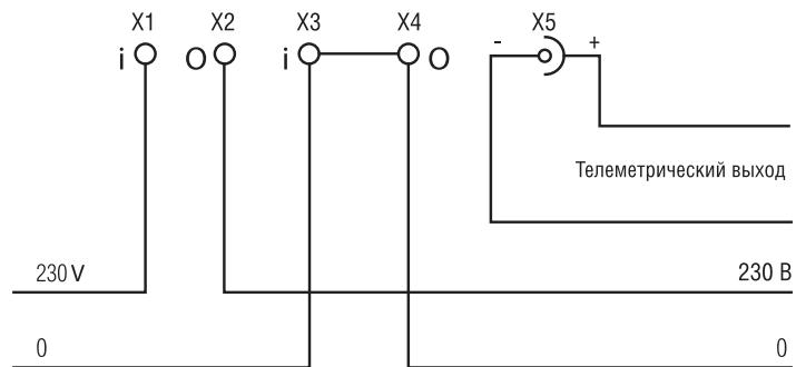
**Рисунок Б. 10.** Схема подключения счетчиков «Меркурий 202, 202Т»
