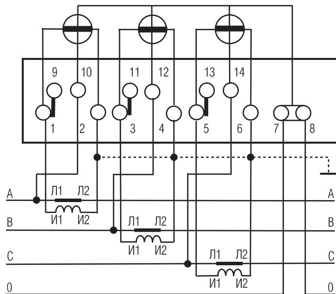
**Рисунок Б. 6.** Схема подключения счетчиков с помощью трех трансформаторов тока
