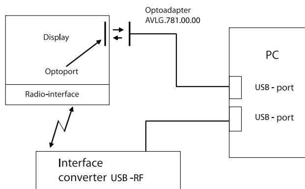
**Рисунок Г. 6.** Схема подключения преобразователя интерфейсов USB-RF
