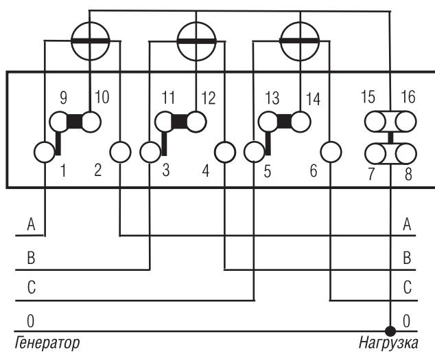
**Рисунок Б.2.** Схема непосредственного подключения
