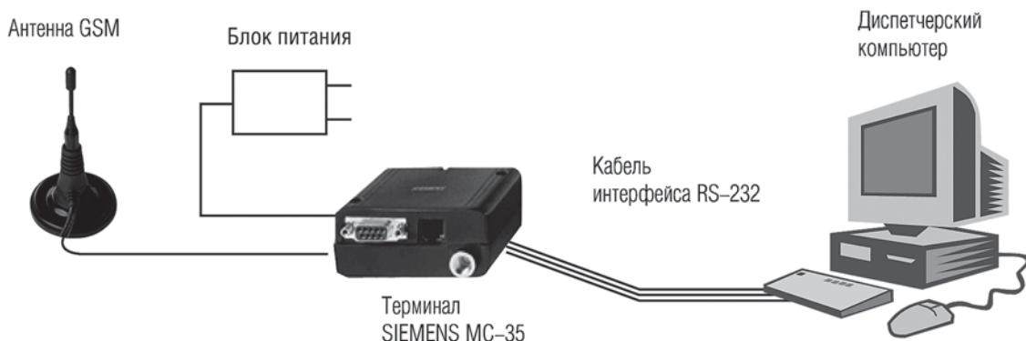
Рисунок Г. 3. Подключение GSM-модема к персональному компьютеру
