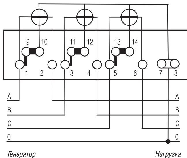
**Рисунок Б. 5.** Схема непосредственного подключения
