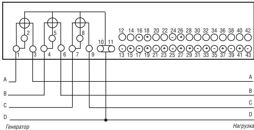
**Рисунок Б. 12.** Схема непосредственного подключения счетчика «Меркурий 233»
