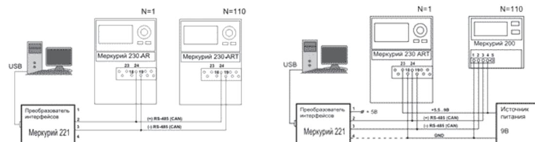
**Рисунок Г. 5.** Схема подключения преобразователя «Меркурий 221»
