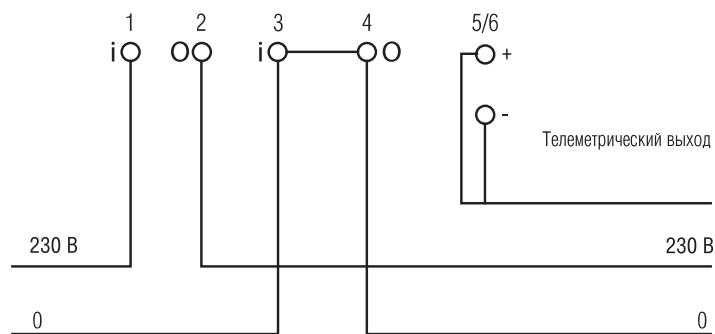
**Рисунок Б. 9.** Схема подключения счетчика «Меркурий 201»
