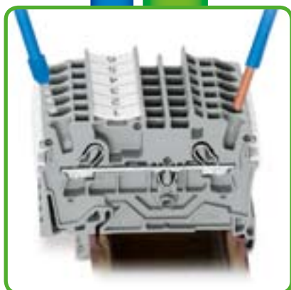
Фронтальный монтаж: Зажим CAGE CLAMP®S, непосредственное подсоединение одножильных проводников и тонких многожильных проводников с наконечниками
