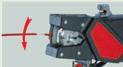
② Скручивание: вставьте многожильный провод между губками инструмента, не снимая изоляцию до конца, и произведите скрутку
