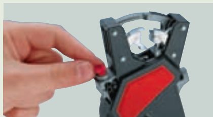
① Настройка инструмента позиция I - 0.5 - 1 мм 2 позиция II - 1.5 - 2.5 мм 2
