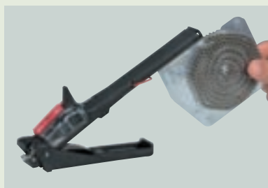
② Установка кассеты большой вместимости
